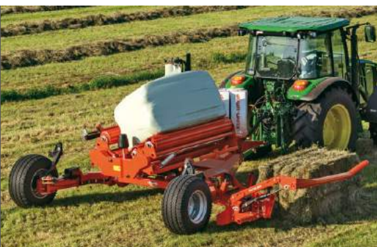
Geïntegreerde Autoload functie op de SW 1614 C
